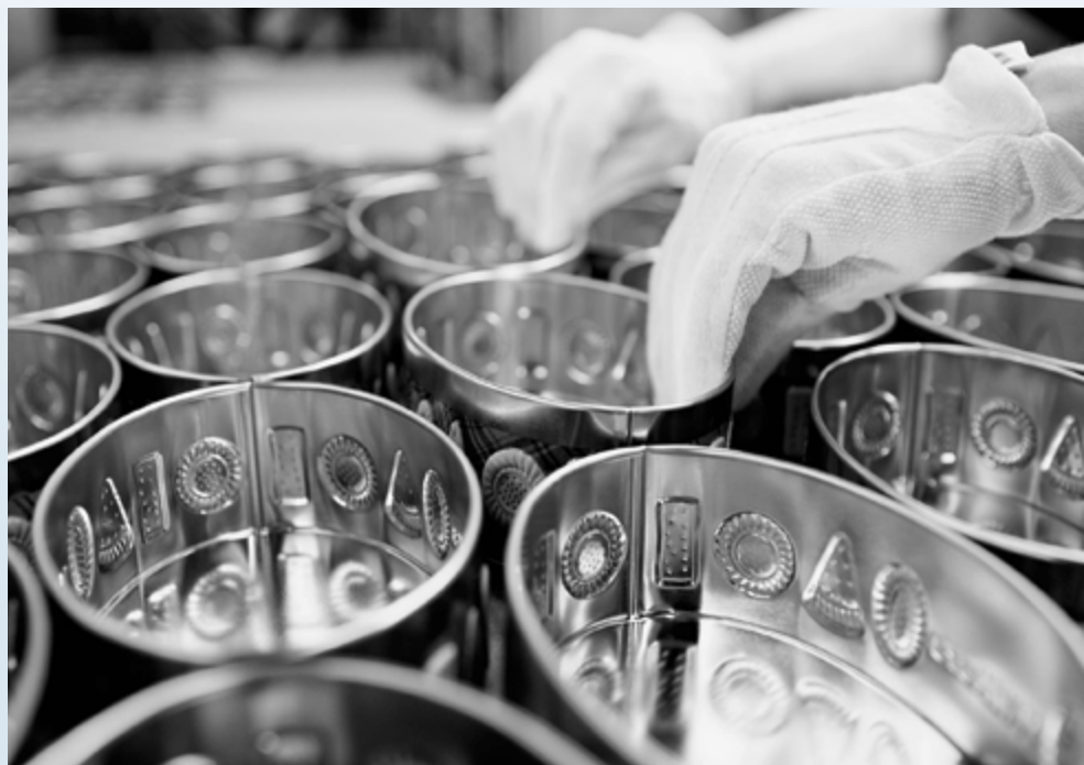
Blechdosen sind auf Grund der sehr guten Migrationsbarriere von Weißblech eine beliebte Umverpackungsart für die Lebensmittelindustrie
