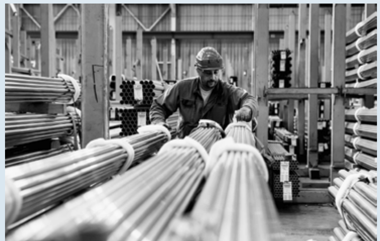
Bündelung und Endkontrolle der Edelstahlrohre vor dem Versand
