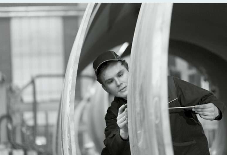
Balcke-Dürr: Vermessen von Mantelschüssen für einen Hochdruckvorwärmer
