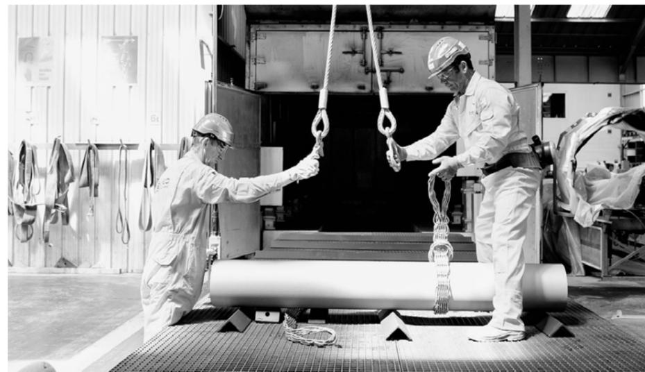
Erhitztes Rohr vor dem Auftragen der Epoxidpulverbeschichtung
