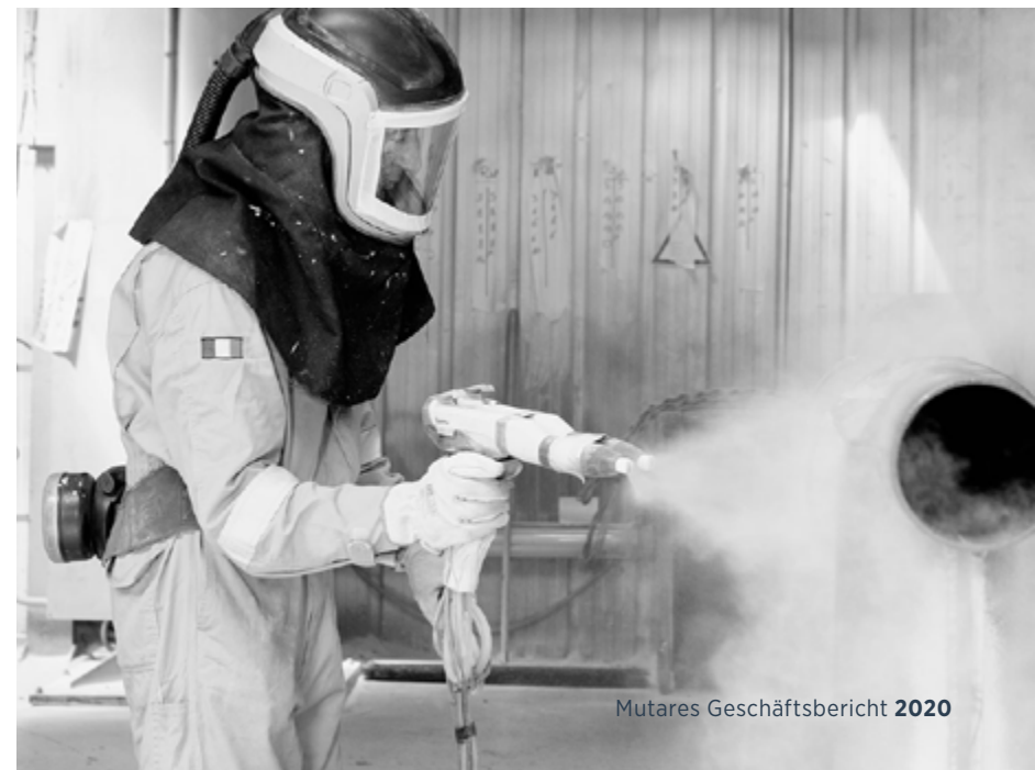
Erhitztes Rohr vor dem Auftragen der Epoxidpulverbeschichtung
