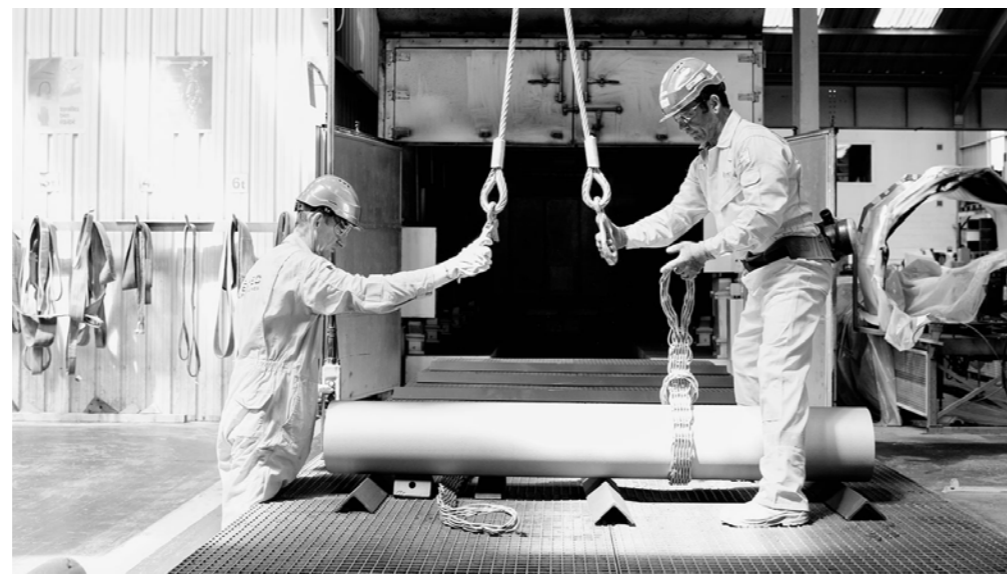
Erhitztes Rohr vor dem Auftragen der Epoxidpulverbeschichtung
