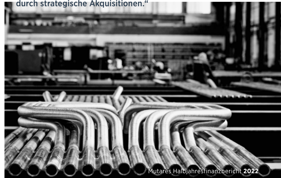
Rohrausbiegungen als Teil eines Austauschs von Kesseldruckteilen
