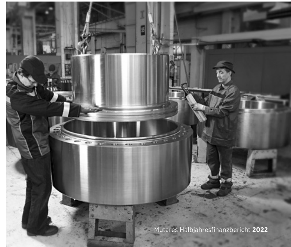
Justierung des Kolbens in einem Walzkraftzylinder für das Walzwerk in der Werkstatt von Clecim
